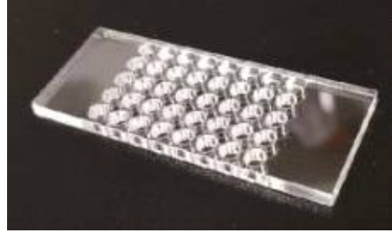
그림 3. 분석기판 실사 모습. 하나의 분석기판에서 최대 40개의 각기 다른 조건을 1 시간 이내에 측정가능하다.
