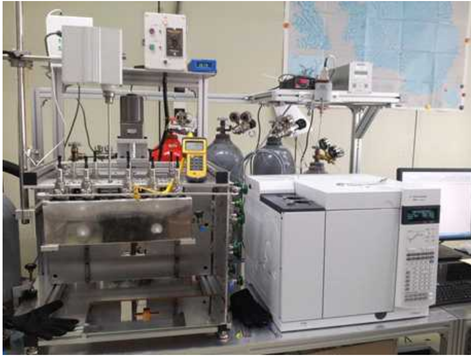
그림 4. 과거 대기 메탄 농도 복원을 위한 빙하코어 공기 추출장치 (서울대학교 빙하/고기후 연구실 제공).
